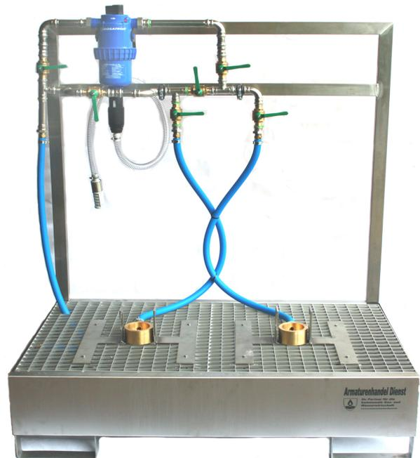
Die stromlose und wartungsfreie Injektorpumpe führt konstant das Desinfektionsmittel vom Kanister dem Spülwasser hinzu, so daß ein gleichbleibender Spülvorgang erreicht wird. Bereits nach kurzer Zeit ist das Standrohr desinfiziert und kann ggf. noch beprobt werden. Sonderausführung für Standrohre BaWü oder Gartenstandrohre mit Adapter als Erweiterungsoption möglich.
